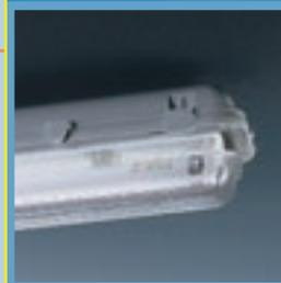
Feuchtraumleuchten, freistrahlend, aus schwer entflammarem, glasfaserverstärktem Polyester. Farbe hellgrau. Der Starter ist von aussen zugänglich. (IP 65, TÜV, GS, F-Kennzeichnung, VDE)
